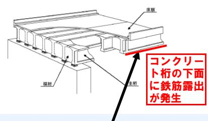
主桁の損傷（鉄筋露出）
